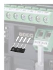
插入不同的模块可得到不同的线尾电阻值。参考下边不同控制主机说明来选择合适的电阻值:
