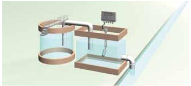
安装在工厂的排水处理设施等处, 监测排放到河流以及下水道的排水浊度。能够掌握人工分析困难的每天及各时间段的变动数据, 从而实现更细致的管理。
