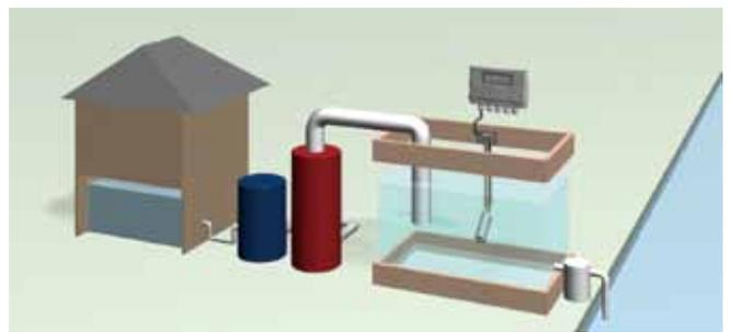
监测简易自来水管的原水浊度, 根据此浊度控制取水泵及阀门, 保证原水的稳定。
